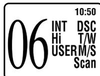
Per interrompere il *Triple Watch* premere il tasto **C** o il **PTT** o il tasto **16** o tramite una chiamata DSC di soccorso.
