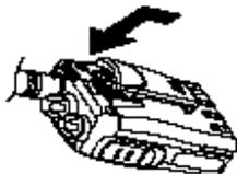
Premere verso il basso la batteria sul retro del ricetrasmittitore fino a quando il blocco posto sul retro della radio si aggancia e blocca la batteria.
