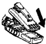
Fare coincidere le 2 scanalature della batteria con le guide corrispondenti sulla parte inferiore del ricetrasmittitore.
