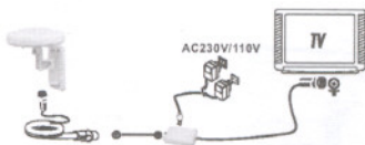
Installazione 1: collegamento diretto alla TV(Fig. 6)
