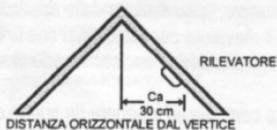
FIG. 4 – Posizione consigliata per il montaggio in locali con soffitto spiovente
