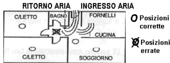
Fig.5 - Posizione consigliata del rilevatore di fumo per evitare correnti d'aria contenenti particelle combuste
