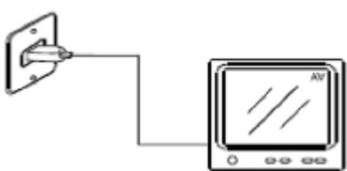
9. Impostare il canale del ricevitore in modo che esso sia lo stesso della telecamera tenendo premuto il tasto di selezione del canale. Le relative immagini appaiono sul monitor/TV.
